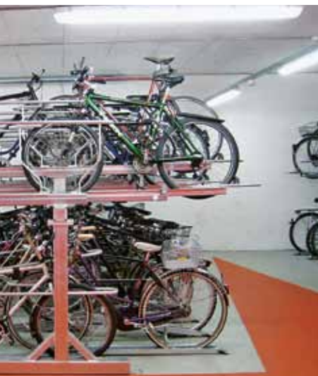
29-4.0 Système à double niveau, surélévation alternée
