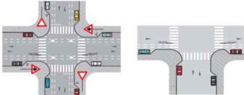
En présence d'une bande de "tourne-à-droite" pour le trafic, la PCM peut être placée **à gauche de la bande de présélection** : les cyclistes sont invités à se positionner correctement en amont du carrefour. Cela permet d'éviter les mouvements conflictuels au niveau du carrefour même, entre les cyclistes qui poursuivent tout droit et le flux automobile qui tourne à droite.
